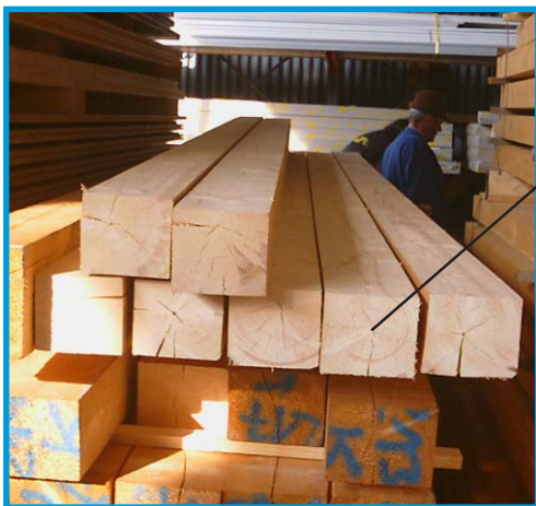
Herz in der Mitte des Pfostens führt zu verstärkter Rissbildung
